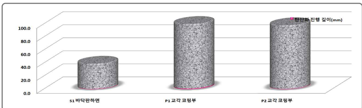
[그림 4.2.4] 탄산화깊이 및 잔여피복두께 측정결과
